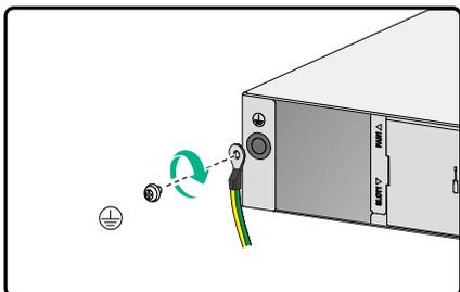
连接保护地线到机房接地排
