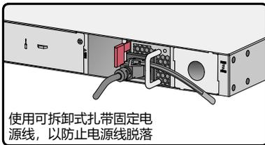
使用可拆卸式扎带固定电源线，以防止电源线脱落
